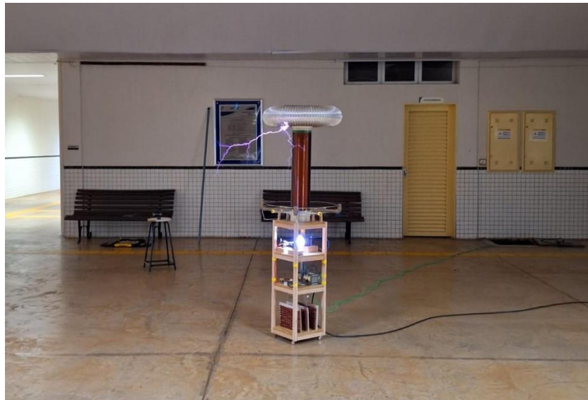
Figura 17 - Teste da Bobina de Tesla
