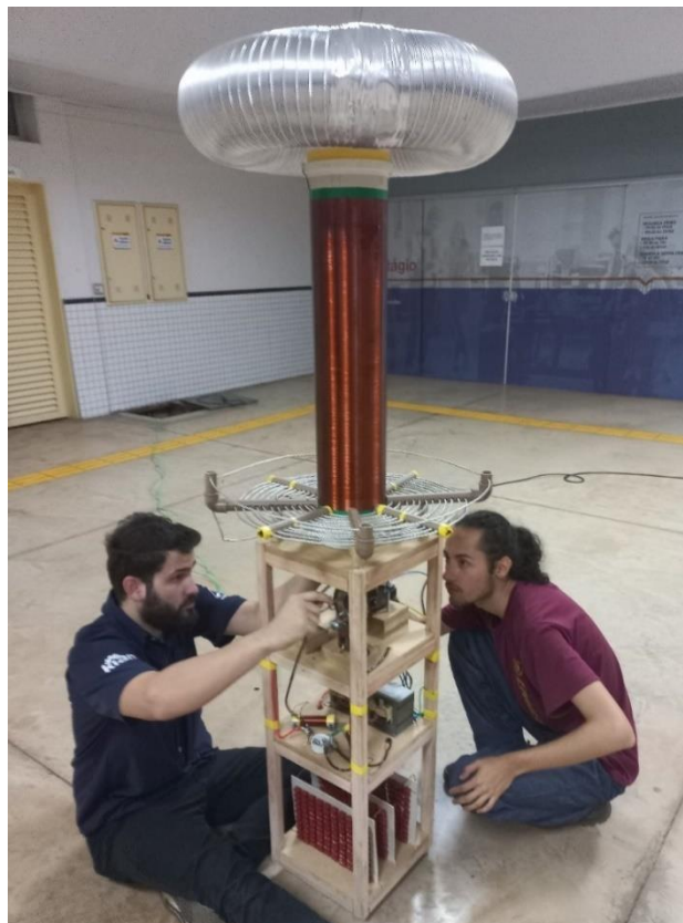
Figura 18 - Ajustando a Bobina de Tesla
