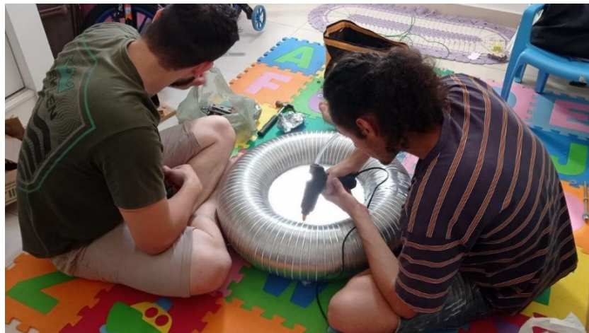
Figura 16 - Construção do toroide da Bobina de Tesla
