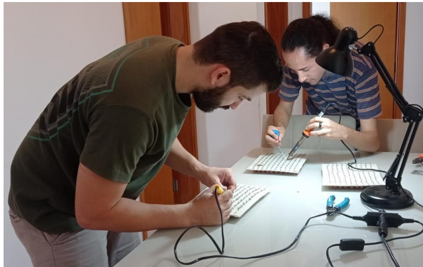
Figura 14 - Construção do banco de capacitores da Bobina de Tesla
