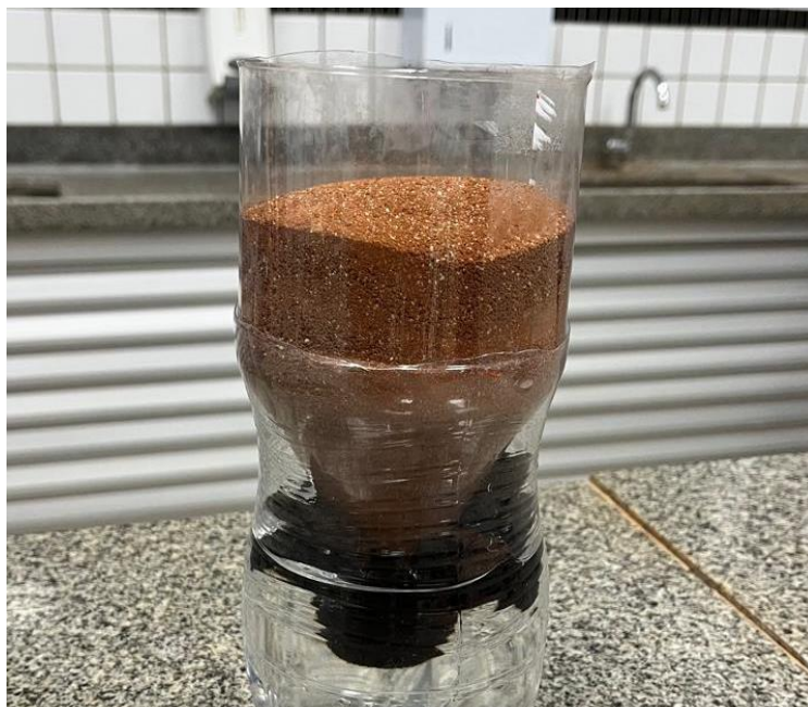
Figura 9 - Método de Leonard utilizado para cálculo de CRA
