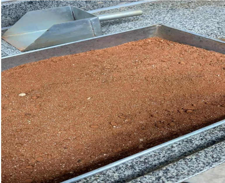
Figura 3 - Mistura 9:1 para amostra de solo e método de Leonard
